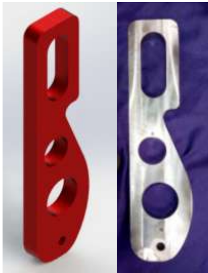
Fig -7: Brake Pedal CAD model and actual component
