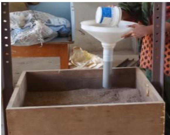
Fig 1: Sand pouring technique
