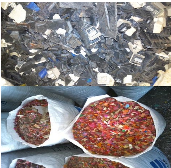
Fig-1: Crushed Non Metallic E-Waste
