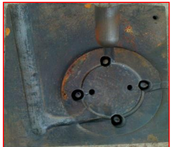
Fig-19: Die after machining
